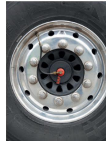
**KONTROLLE** Der Reifendruck wird überwacht und bei Bedarf ausgeglichen.
