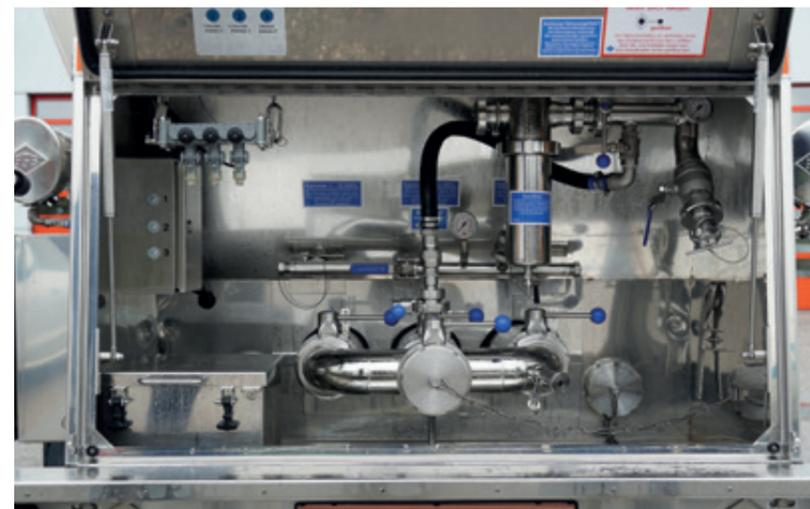
**AUFGERÄUMT** Einige der foodsped-Fahrzeuge sind zusätzlich mit Lebensmittelpumpe ausgestattet, mit Frequenzsteuerung und beheizbar.
